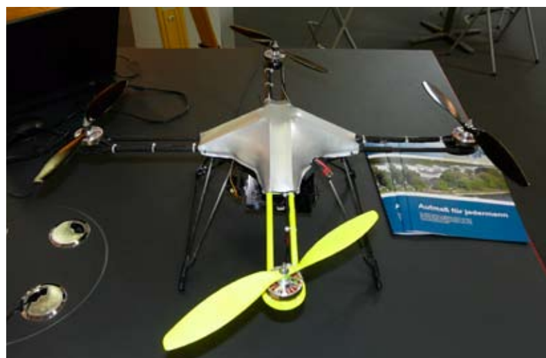
Das kleine Fluggerät hat vier Rotoren, eine Kamera und wird mittels Fernsteuerung geflogen.
