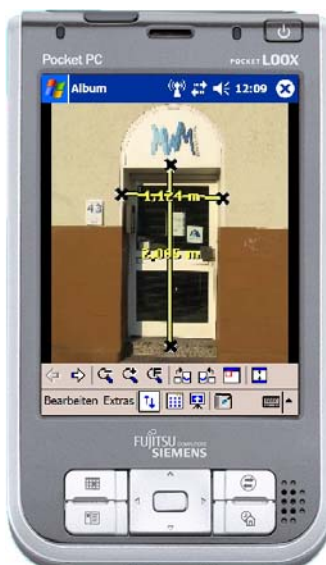
Mit der Hilti-Anwendung "ImageSketch" erzeugtes Aufmaßbild
